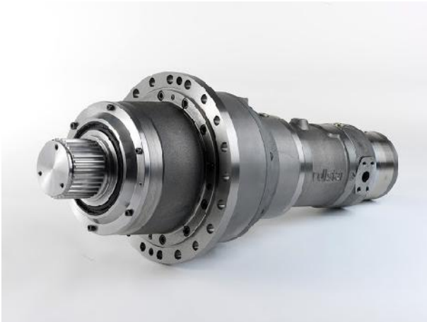
Rollstar Hydraulikmotor mit angebauter Rollstar Federdruckbremse, 2 Getriebestufen und verstärkter Abtriebslagerung für verzahnte Welle zur Aufnahme eines Ritzels.
