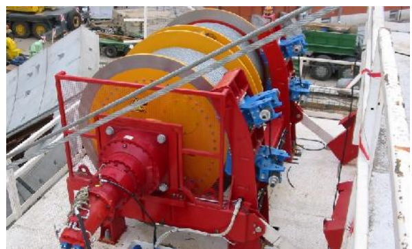
Planetengetriebe als Windenantrieb für Schachtanlage im Bergbau
